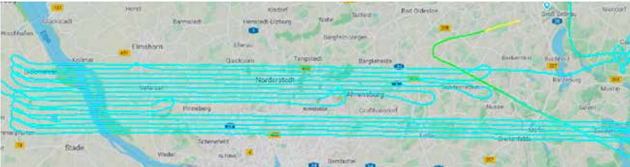
Beispiel für ein typisches linienförmiges Flugmuster bei der 3D-Datenerfassung Example of a typical linear flight pattern during 3D data acquisition
